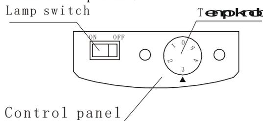
3. Vérifier si le bouton est à une position adéquate avant l'utilisation de l'appareil. Il est déconseillé de le régler lorsqu'il est en fonctionnement. Pendant l'été, la température ambiante est élevée, le bouton se positionne sur "2". Pendant l'hiver, la température ambiante est basse, le bouton se positionne sur "4".
